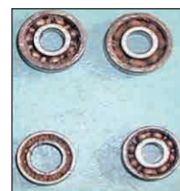
Abb. 3-5: Verfärbte Oberflächen durch ungeeignete Reinigungsmittel oder Wasserqualität
