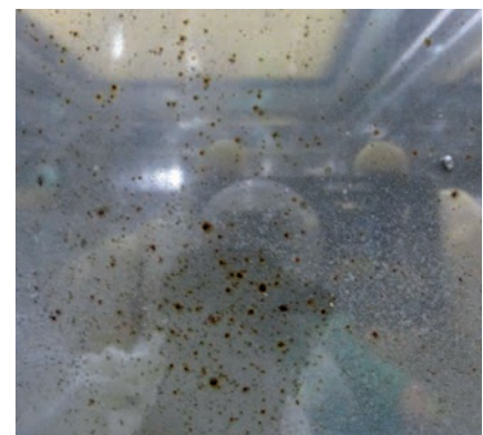
Abb. 10: Korrosion an der RDG-Kammer-Rückwand
