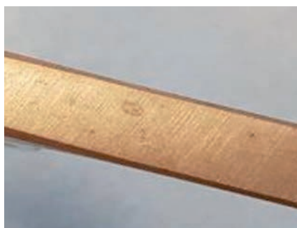
Abb. 3: Beispiel geringfügiger Korrosion
