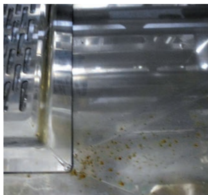
Abb. 9: Korrosion in der RDG-Kammer unten
