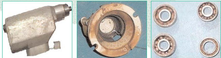
**Abb. 3 bis 5:** Verfärbte Oberflächen durch ungeeignete Reinigungsmittel oder Wasserqualitäten
