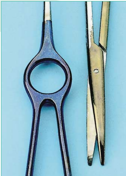
Abb. 1: Anlauf Farben – bunt schillernde Silikatbeläge*
