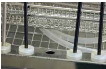
Abb. 2: Spüleiste, bei der ein Anschlussstopfen fehlt
