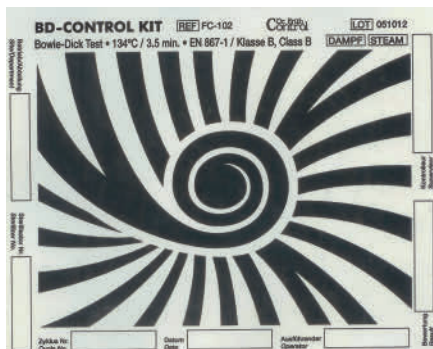
Abb. 2: Testbogen Farbumschlag in Ordnung
