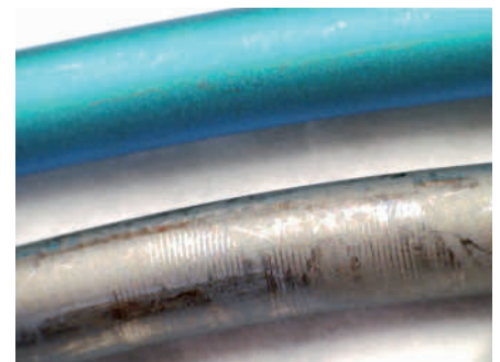
Abb. 2: Farbveränderung von Titan durch die Aufbereitung
