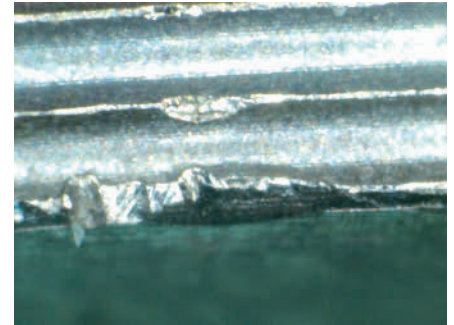
Abb. 1: Mechanische Schäden an einer Schraube durch maschinelle Aufbereitungen
