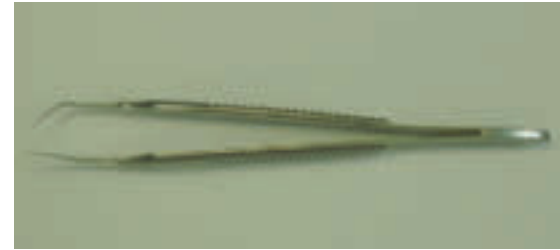
Abb. 2: Mechanischer Schaden an Kapsulohexipinzette Werksfoto Geuder
